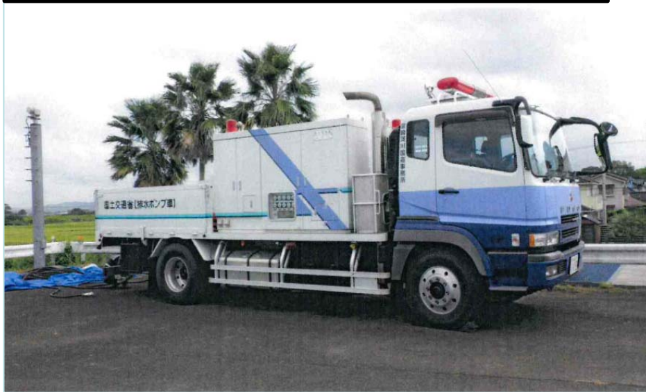
2.5m 3 /秒級(ポンプ0.5m 3 /秒×5台搭載)排水ポンプ車
