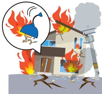
白熱灯の落下により出火
