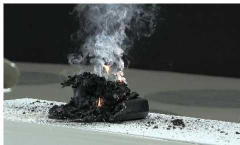
電動アシスト自転車用非純正バッテリーの発火 (再現イメージ)
