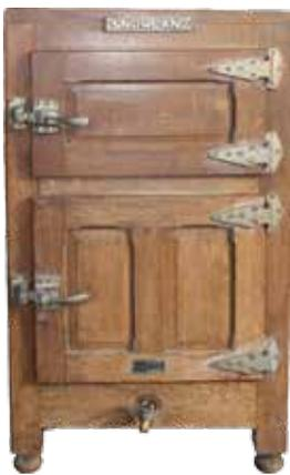
食料の冷却や貯蔵に使う冷蔵庫は、現在は電気で作って冷やしていますが、かつては氷を使って冷やしていました。電気のない時代に発明された氷冷蔵庫は、上段に氷を入れ、その冷気で下段の食料を冷やしました。その構造は、木製の箱の内部にブリキ板が貼ってあり、冷気が外に逃げない仕組みになっていました。そして、氷は氷屋が家の前まで自転車やリヤカーで運び、適当な大きさに切り出して台所へ持ってきてくれていました。
