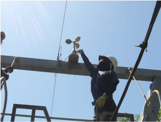
風速計動作確認
