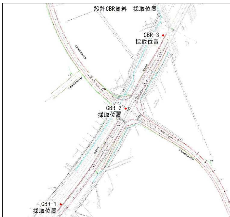
図 3-16 CBR 試験採取箇所位置図
