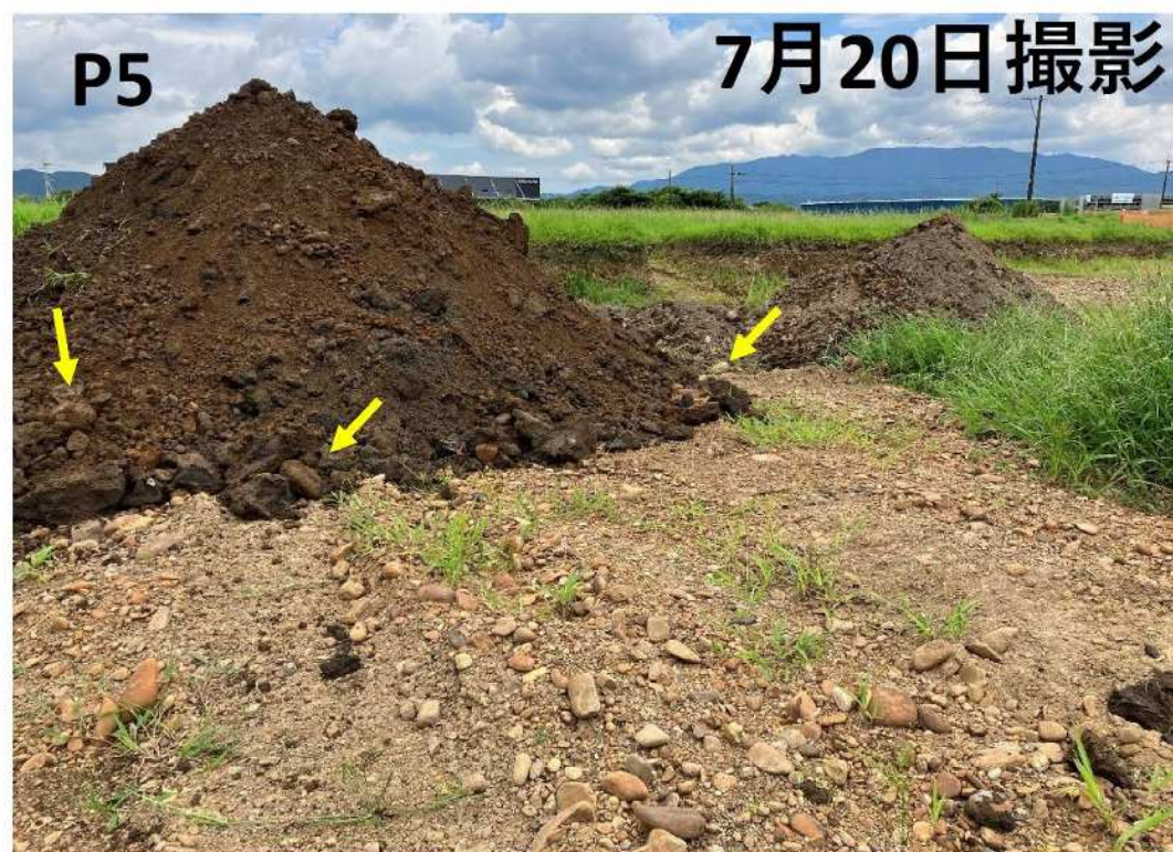
掘削した砂礫層中には礫径約30cmを超える大きなものも含まれていた。（黄色矢印）
