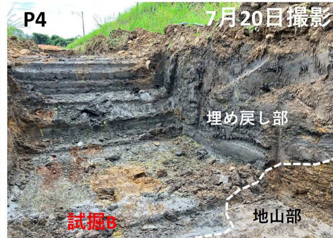
元々CO構造物があった箇所は、青灰色の粘土～シルト（埋め戻し土）が分布する。一方、地山部は茶～茶褐色の砂礫層が分布する。
